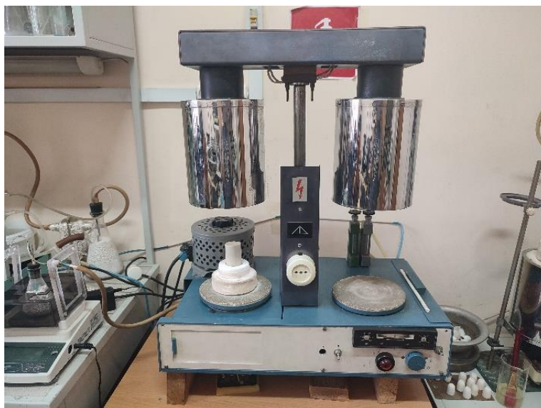
Рисунок 20 – Электродпечь с герметичным реактором, подключенным к установке вибрации
