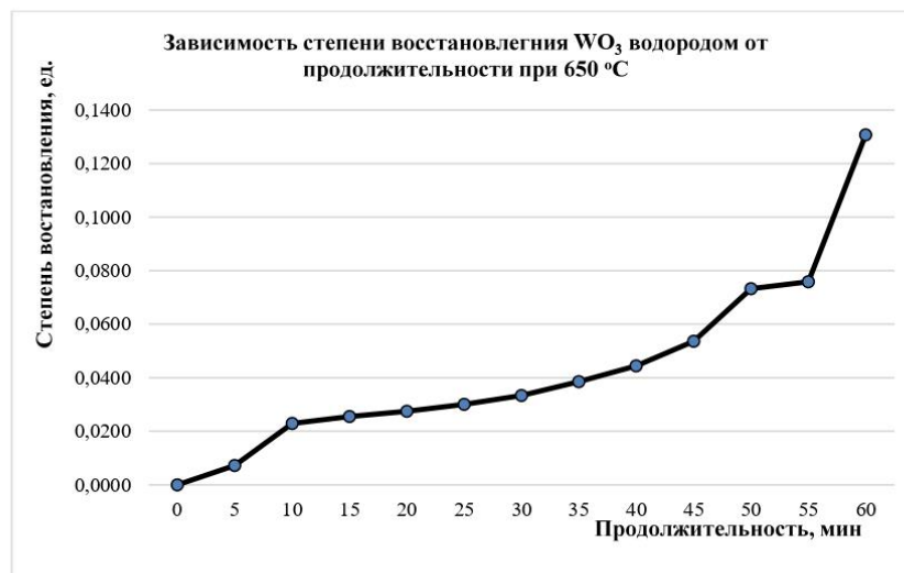
Рисунок 4. График зависимости степени восстановления оксида вольфрама водородом от продолжительности при 650°C
